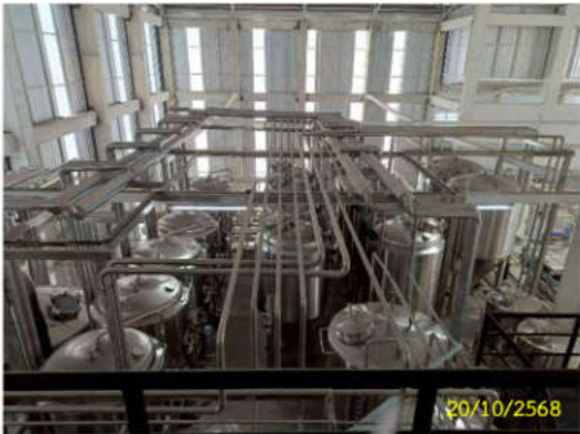
รูปที่ 3 ถังหมัก/บ่มผลิตเบียร์ของโครงการที่มีการปิดมิดชิด
